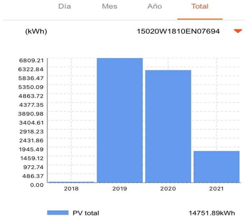
Figura 4 - Medições de energia elétrica gerada, em 2019 e 2020, por conjunto fotovoltaico instalado na CRO/12, em Manaus. Fonte: Amazonas Energia SA.
