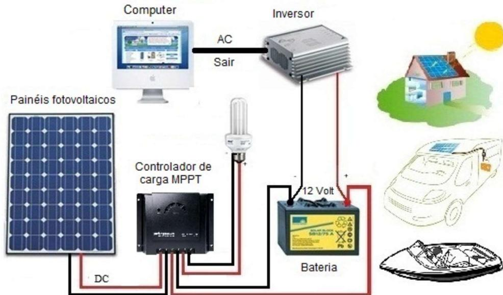
Figura 2 – Diagrama elétrico fotovoltaico, Sistema on grid; Fonte: Mppt Solar (2016)
