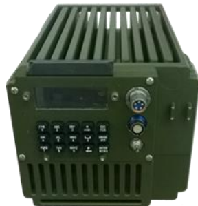
Figura 5 – Rádio VHF 3088 MHz Veicular
