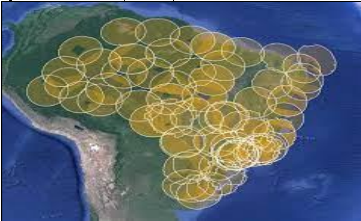
Figura 8 – Cobertura dos radares que utilizam o protocolo ASTERIX no Brasil
