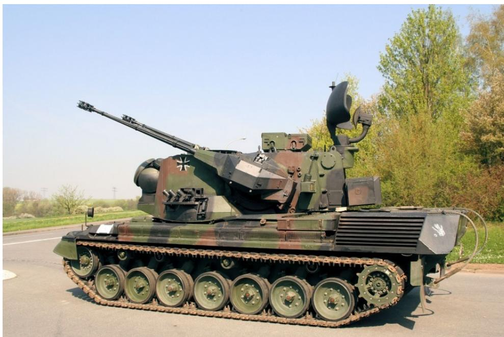
Figura 3: VBC Aae GEPARD 1A2 e seu canhão AAe Oerlikon 35mm (PADILHA, 2013).
