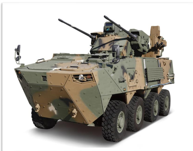
Figura 14: AAGW montado no Hyundai Rotem 8x8 K808
