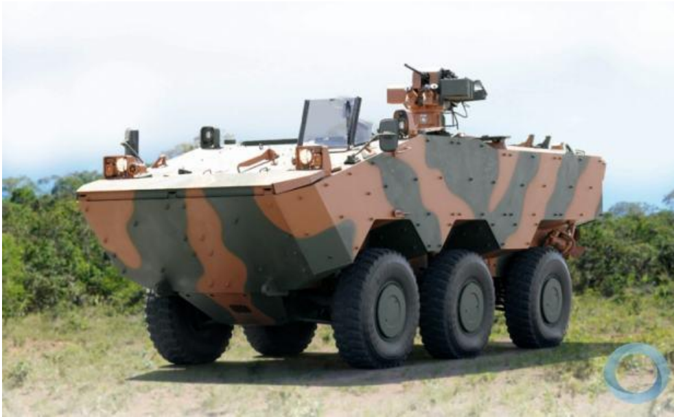
Figura 4: VBTP-MSR Guarani equipado com sistema REMAX
