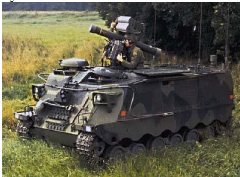
Figura 8: Sistema antiaéreo RBS-70 montado em veículo blindado.
