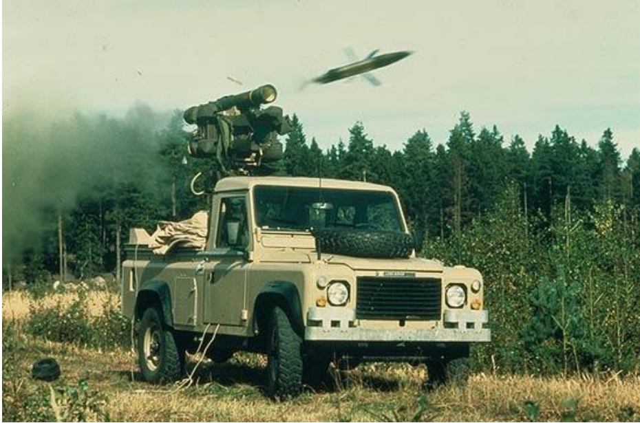
Figura 7: Sistema Antiaéreo RBS-70 montado em Land Rover.
