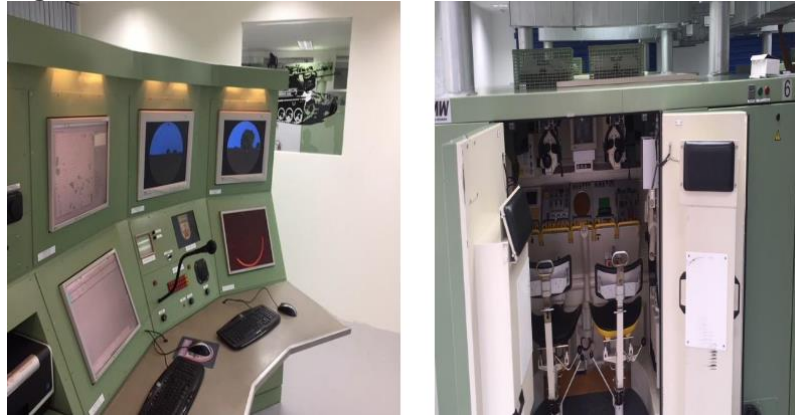
Figura 4 – Simulador da Torre AAe da VBC GEPARD 1A2
