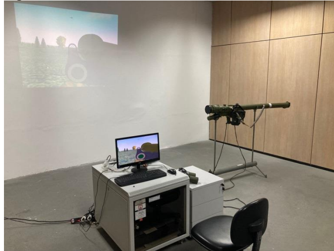
Figura 3 – Simulador do Msl IGLA
